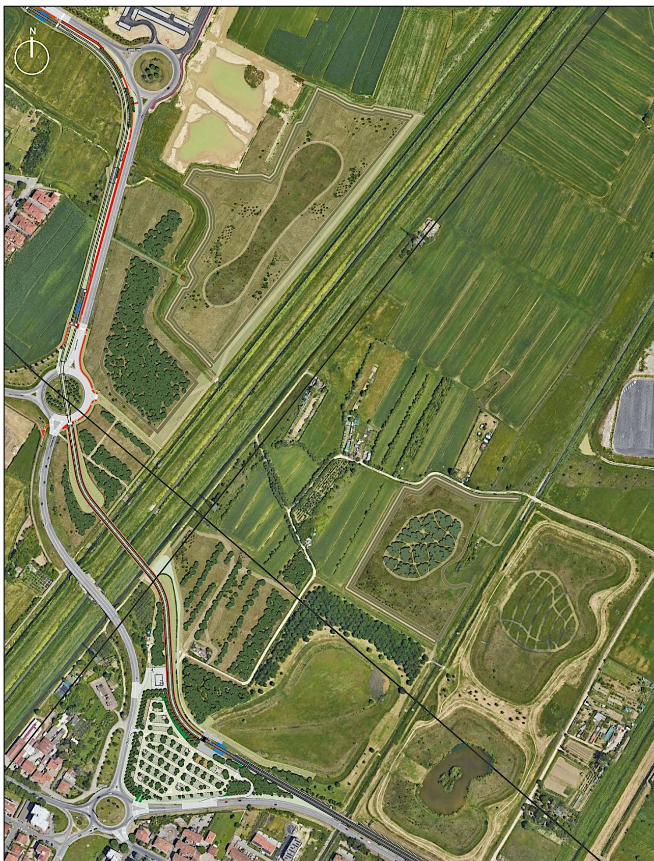
FIG. 24 PLANIVOLUMETRICO DEGLI INTERVENTI DELLE AREE DI COMPENSO IDRAULICO (AC) E DELLE AREE INTEGRATIVE (AI)
