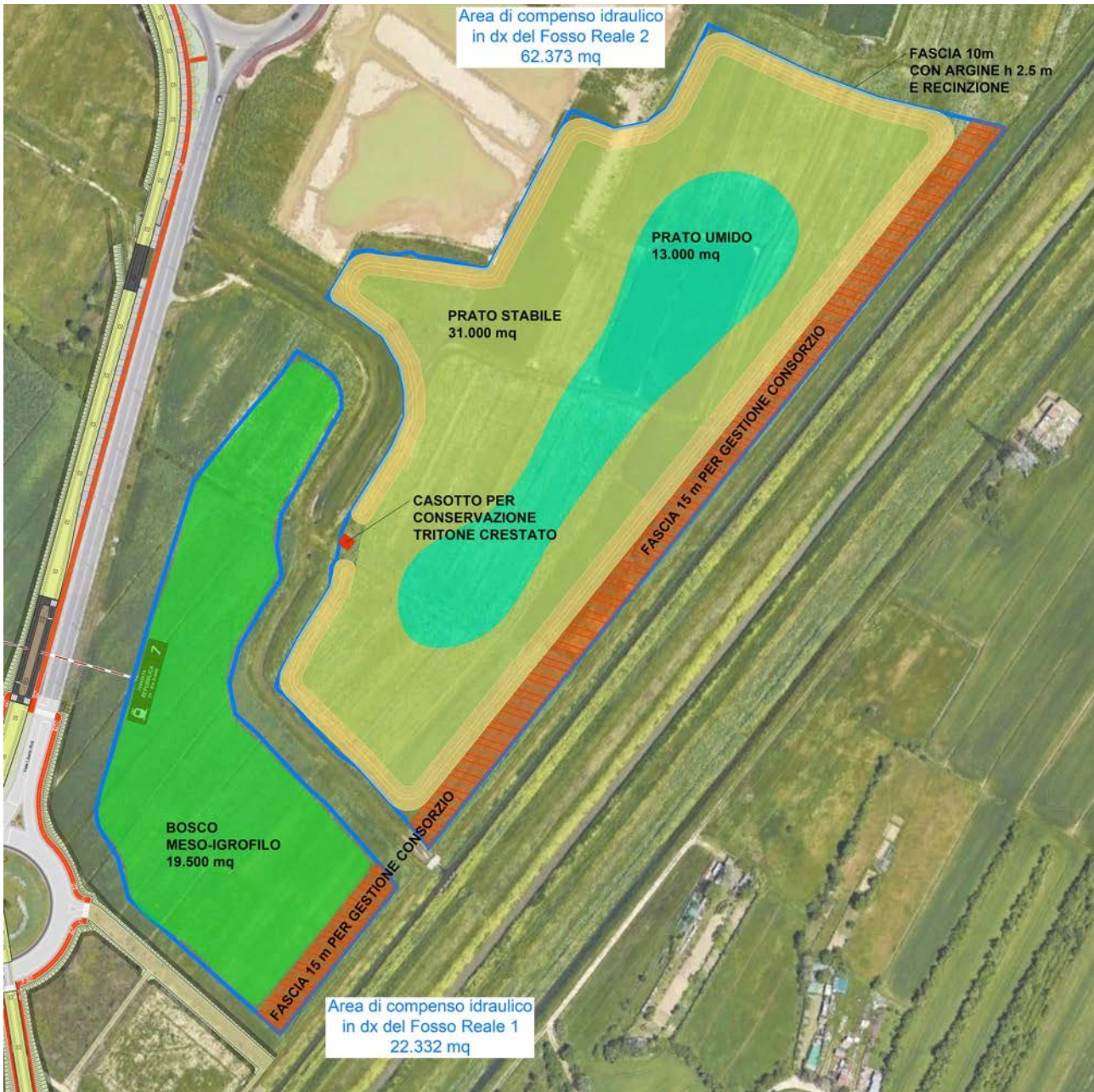
FIG. 11 ESTRATTO DELLA TAVOLA GENERALE DI PROGETTO RIGUARDANTE LA ZONA DI INTERESSE PER LA REALIZZAZIONE DELLE DUE CASSE DI ESPANSIONE FOSCO REALE 1 E FOSCO REALE 2 CON ALL'INTERNO I NUOVI HABITAT (FONTE: FL42-D-V-PA-PG-00-EGG-AB-07-A ALLEGATO 7 - TAVOLA "OPERE COMPENSATIVE (L.R. N. 39 DEL 21/03/2000 ART.44 RIMBOSCHIMENTO COMPENSATIVO) AVENTI ANCHE VALORE DI MITIGAZIONI PER LA ZSC-ZPS IT 5140011 STAGNI DELLA PIANA FIORENTINA E PRATESE" A0 1:1.000)
